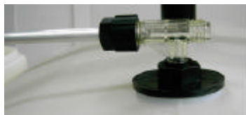
Bild 7.3 a: Alu-Saugleitung 10 x 1 mm
