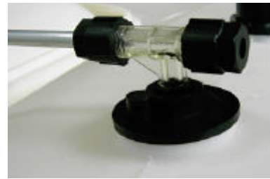
Bild 7.3 c: Verschlussstopfen mit Kappe fertig montiert
